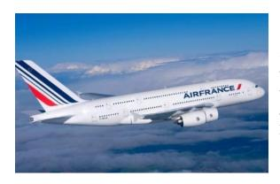
« Le Géant des airs », l'A380. Avec une longueur de 72 mètres, une hauteur de 24 mètres et une envergure de 79 mètres. Il peut transporter le nombre impressionnant de 516 passagers et atteindre une vitesse de croisière maximale de 950 km/h. C'est le plus gros avion existant de nos jours.
